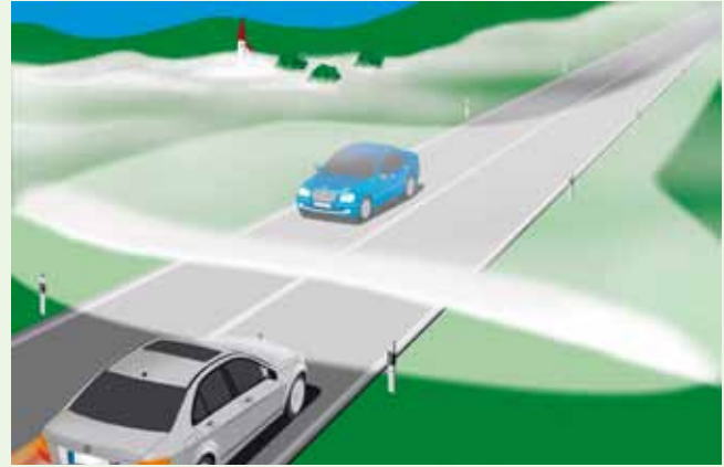
Distribution du faisceau de l'éclairage antibrouillard élargi (Illustration : Daimler AG)
