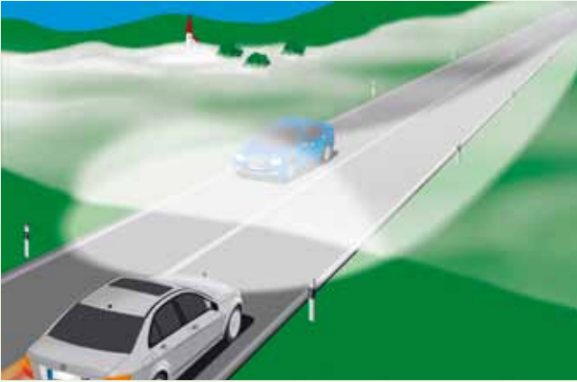
Distribution du faisceau de l'éclairage antibrouillard standard en situation (Illustration : Daimler AG)
